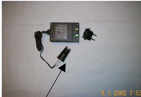
Ladeplug erst in den Tank schrauben dann Kabel anschließen, dann in die Steckdose
