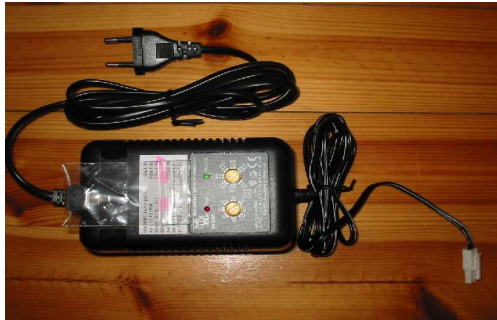
Lader 600 mAh. Der kleine Schlüssel dient zur Einstellung des jeweiligen Akku
